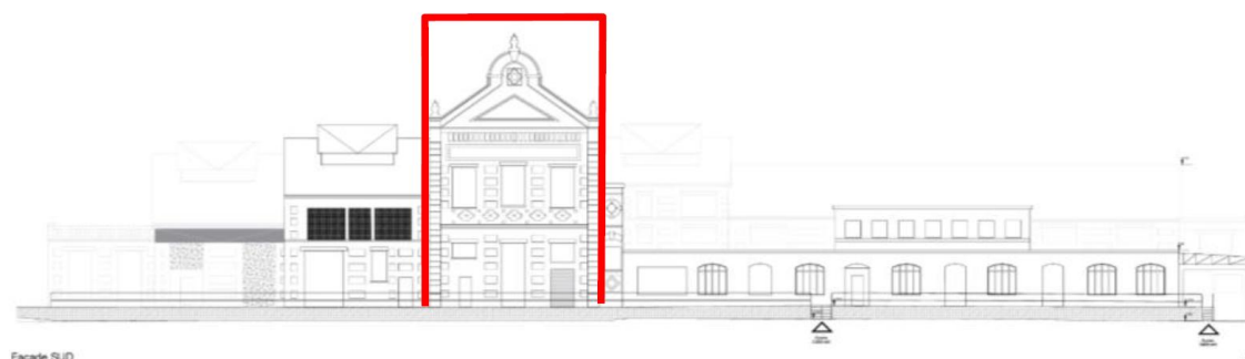
Eléments conservés : réhabilitation de la nef principale
